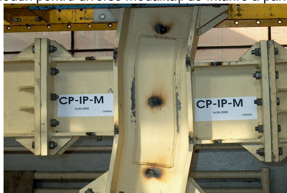
Figura 60 arată un exemplu de deformație ultimă pentru panoul stâlpului (încărcare monotonă)
