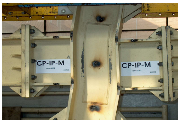
Figura 60: Modul de deformare al panoului de inimă al stâlpului (Ciutina, 2008).
