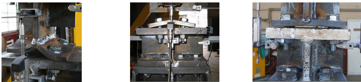
Figura 78: Moduri de cedare pentru elementul T echivalent înregistrate experimental.
